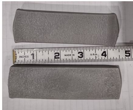
(d) 8 th pass 57.8% reduction post anneal
